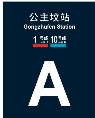
图64 换乘车站的出入口编号标志示例
