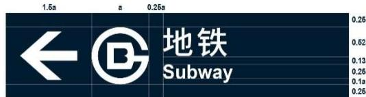
图2 单层标志版面尺寸关系示例
